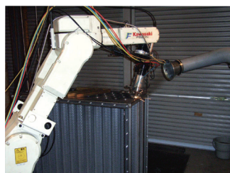
コンデンサーチューブのレーザー溶接
